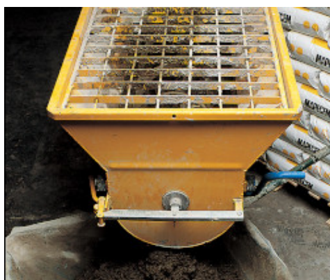
Mapecem bekeverése mini-adagológéppel
